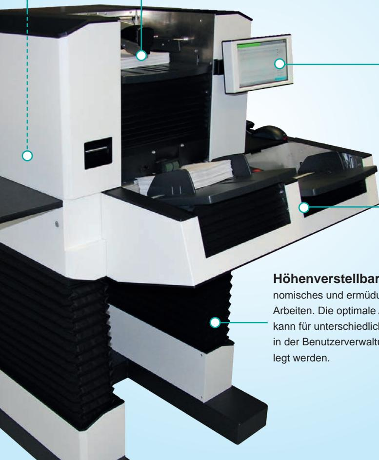
**Höhenverstellbar** für ergonomisches und ermüdungsfreies Arbeiten. Die optimale Arbeitshöhe kann für unterschiedliche Bediener in der Benutzerverwaltung hinterlegt werden.
